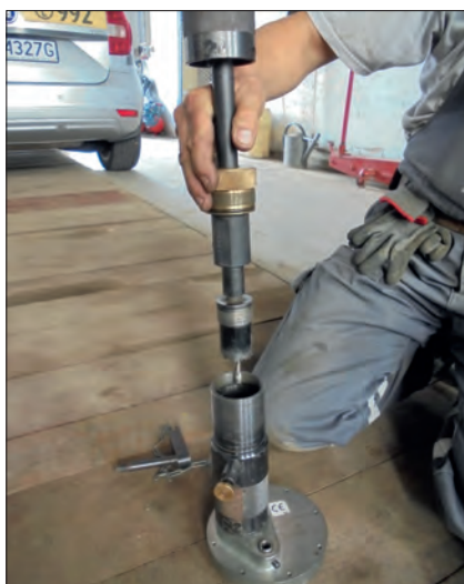
Rys. 2. Urządzenie do wiercenia TDW, fot. autora
