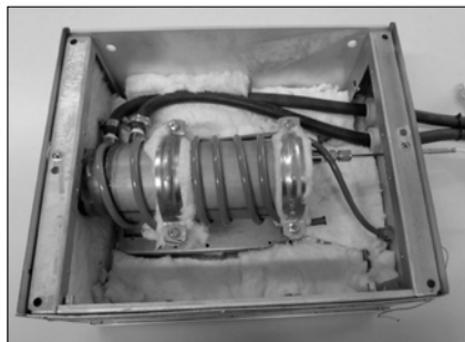
Rys. 8. Emiter wraz z płaszczem w obudowie termoizolacyjnej Fig. 8. Emitter with a jacket in a thermal insulation housing
