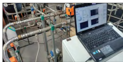
Rys. 3. Stanowisko do badań przepływowych armatury Fig. 3. Research stand for the flow armature testing
