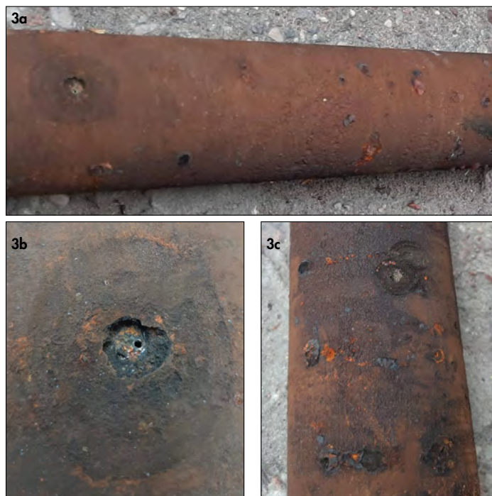
Rys. 3. Uszkodzona płomieniówka kotła 3a, oraz zbliżenia uszkodzeń 3b i 3c
