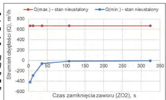
Rys. 9. Przebieg zmian wartości maksymalnego ( Q(\max.) – stan nieustalony) i minimalnego ( Q(\min.) – stan nieustalony) strumienia objętości ( Q ) w rurociągu przesyłowym, przedstawiony w funkcji całkowitego czasu zamknięcia zaworu (ZO2).
