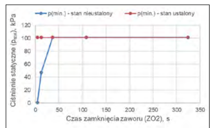
Rys. 8. Przebieg zmian wartości minimalnego ciśnienia statycznego ( p(\min.) – stan nieustalony) w rurociągu przesyłowym, przedstawiony w funkcji całkowitego czasu zamknięcia zaworu (ZO2). Dla celów porównawczych zamieszczono przebieg zmian wartości minimalnego ciśnienia statycznego ( p(\min.) – stan ustalony), dla którego zawór (ZO2) jest cały czas otwarty.
