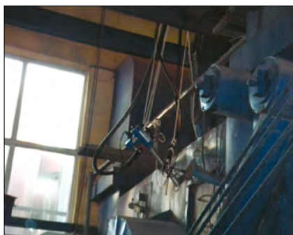
Fig. 2. Placing the probe during experimental research Rys. 2. Umieszczenie sondy pomiarowej podczas badań eksperymentalnych
