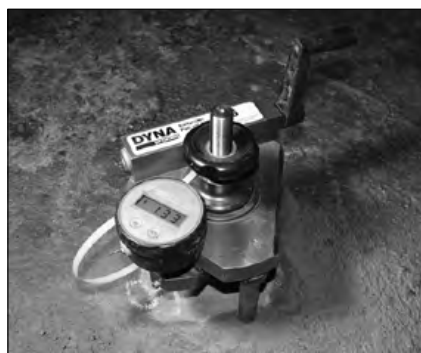
Rys. 8. Badanie „pull-off” Fig. 8. Pull-off test
