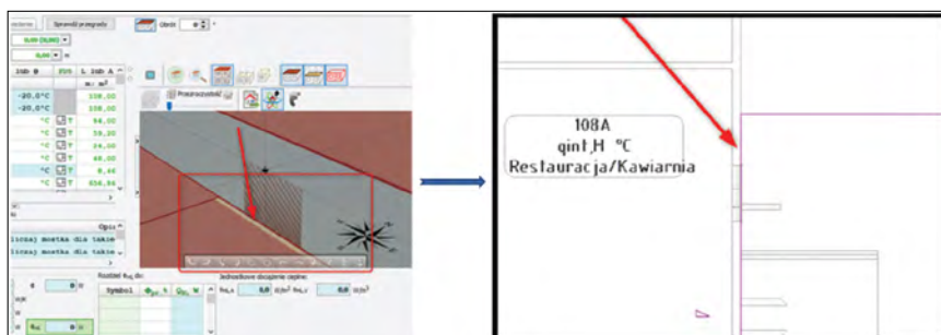
Rys. 6. Przykład źle narysowanego dachu (opracowanie własne) Fig. 6. An example of a badly drawn roof (own work)
