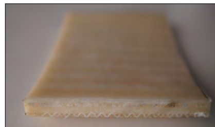
Fot. 12: Fragment rękawa z widocznymi warstwami tkaniny poliestrowej, polietylenu oraz tkaniny z dodatkami włókna szklanego Pic. 12: A piece of a sleeve with visible layers of polyester fabric, polyethylene and fabric with the addition of glass fiber
