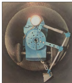
Fot. 18. Napędzone elektrycznie urządzenie do cementowania z łopatkami wygładzającymi Pic. 18. Electrically powered cementing machine with smoothing blades
