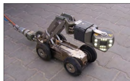
Rys.4. Mobilne laboratorium do badania infrastruktury podziemnej oraz kamera kanalizacyjna firmy Raush [2] Fig.4. Raush's mobile underground infrastructure testing laboratory and sewer camera [2]
