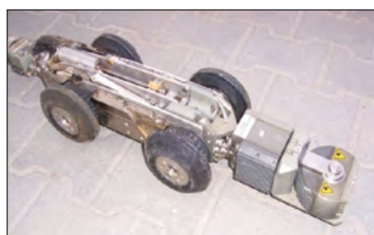
Rys.4. Mobilne laboratorium do badania infrastruktury podziemnej oraz kamera kanalizacyjna firmy Raush [2] Fig.4. Raush's mobile underground infrastructure testing laboratory and sewer camera [2]
