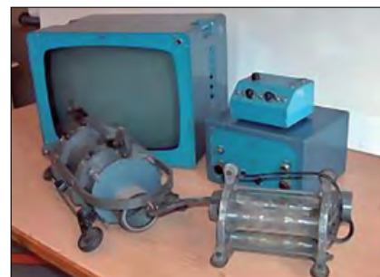
Rys. 1 Pierwszy polski zestaw inspekcyjnej kamery kanalizacyjnej [2]
