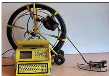
Rys. 2 Kamera kanalizacyjna brytyjskiej firmy Pearpoint oraz kołowrót z nawiniętym kablem i urządzeniem sterującym [2] Fig. 2 Pearpoint's sewer camera including reel with wound cable and control device [2]
