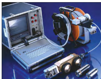
Rys. 3 Kamera kanalizacyjna niemieckiej firmy itv GmbH zakupiona przez Firmę EuroKan s.c. [2] Fig. 3 Sewage camera of German company itv GmbH purchased by EuroKan company [2]
