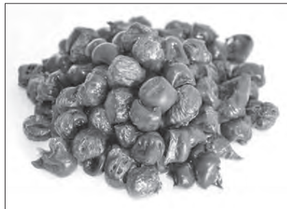
Rys. 7. Kruszywo lekkie wyprodukowane z odpadów tworzywa sztucznego [4] Fig. 7. Light aggregate produced from plastic waste [4]
