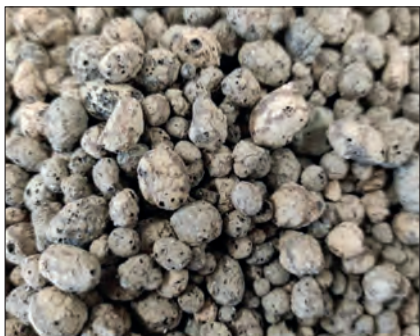
Rys. 5. Kruszywo lekkie Leca Keramzyt (opracowanie własne) Fig. 5. Leca Keramzyt lightweight aggregate (author's work)
