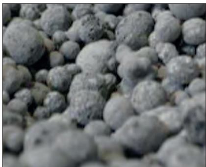
Rys. 6. Kruszywo lekkie z szkła piankowego Penostek (opracowanie własne) Fig. 6. Light aggregate made of Penostek foam glass (author's work)
