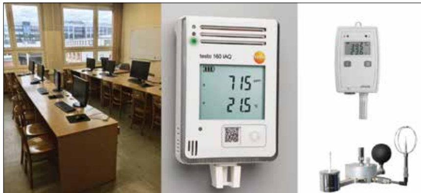
Fig 1. View of the tested computer laboratory (on the left), the testo 160 IAQ recorder [33] (in the middle), APAR recorder [32] (top right corner) and thermal comfort meter module [34] (bottom right corner) Rys. 1. Widok badanego laboratorium komputerowego (po lewej), miernika testo 160 IAQ [33] (po środku), rejestratora APAR [32] (górny prawy róg) i modułu miernika mikroklimatu [34] (dolny prawy róg)
