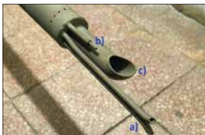
Rys. 2 Końcówka zintegrowanej sondy konstrukcji Instytutu Energetyki: a) sonda Prandtla typu „S”; b) termopara typu „K”; c) sonda do odsysania spalin z popiołem lotnym Fig. 2 The tip of the integrated probe of the Institute of Power Engineering construction: a) the Prandtl probe of type „S”, b) the „K” type thermocouple, c) the flue gas suction probe with fly ash
