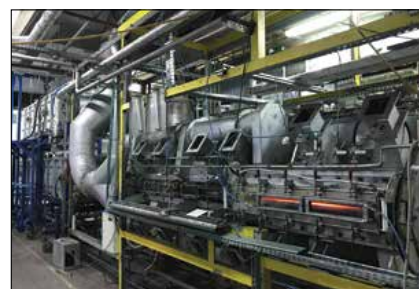
Rys. 6 Stanowisko typu bench-scale m.in. do badania katalizatorów Fig. 6 Bench-scale facility catalysts testing
