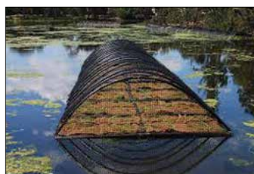
Rysunek 6 Przykład ochrony pływającej wyspy hydrofitowej przed zniszczeniem w okresie rozruchu (źródło: https://harrisenvironmental.com.au/wp-content/uploads/2016/09/DSC_0205.jpg ) Figure 6 An example of protecting a floating treatment island against damage during the start-up phase (source: https://harrisenvironmental.com.au/wp-content/uploads/2016/09/DSC_0205.jpg )
