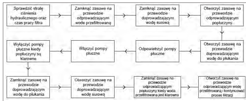
Rys. 7. Schemat blokowy procedury płukania filtrów Fig. 7. Block diagram of the filter backwashing procedure
