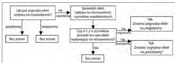
Rys. 2. Zasady korekty poziomu wpływu na niezawodność dla czynników CPC współzależnych (na podstawie [2]) Fig. 2. Rules for adjusting the level of impact on reliability for interdependent CPC factors (based on [2])
