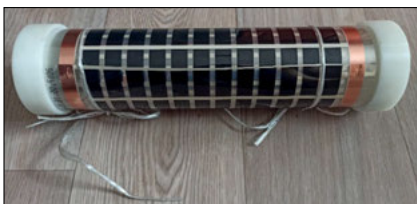
Rysunek 2 Folia grzewcza nawinięta na krążek teflonowy Fig. 2 Heating foil wound on a teflon disc
