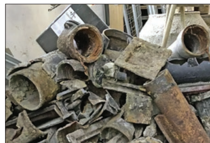
Rys. 2. Zdeponowane fragmenty wykutych rur żeliwnych [1]
