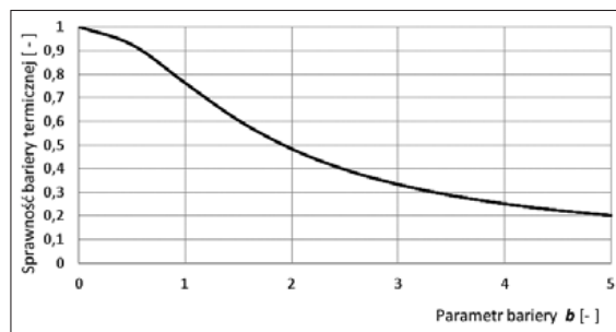
Rys. 2. Sprawność bariery termicznej w zależności od wartości parametru b Fig. 2. Thermal barrier efficiency depending on the value of the coefficient b
