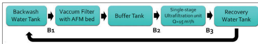
Figure 1. Block diagram of the water recovery system Rysunek 1. Schemat układu odzyskiwania wody
