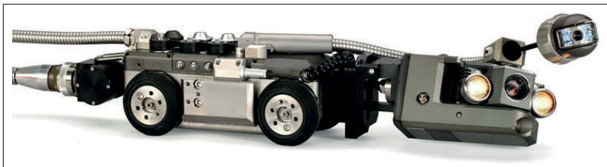
Rys.6. Kamera przejezdna z opcją kamery satelickiej [12] Fig.6. Mobile camera with satellite camera option [12]
