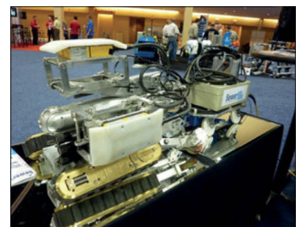
Rys.7. Georadar przemieszczający się wnętrzem kanału (zdjęcie własne z wystawy konferencyjnej) Fig.7. Ground penetrating radar moving inside the sewer (own photo from the conference exhibition)
