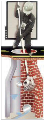
Rys. 1. Nieprzejezdna kamera ze zmienną ogniskową [2] Fig. 1. Immobile camera with variable focal length [2]
