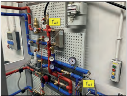
Rys. 7. Zdjęcie instalacji pomiarowej – pomiar temperatur wody chłodzącej Fig. 7. Picture of tested installation – cooling water temperatures measurement
