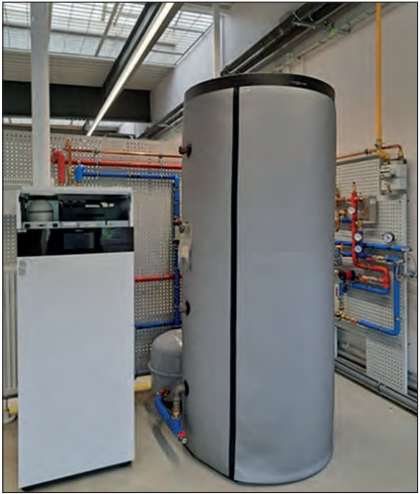
Rys. 5. Zdjęcie badanego ogniwa paliwowego z zasobnikiem ciepła Fig. 5. Picture of tested fuel cell with heat accumulator
